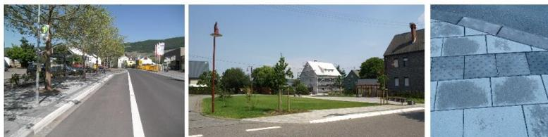
**Beispiele für ebenerdigen Einstieg durch Buskantensteine und taktile
